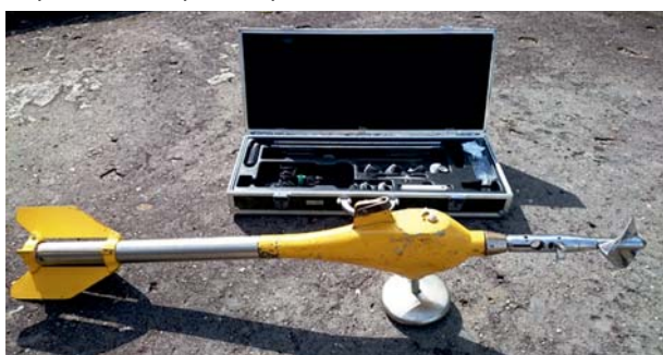
Figura 2: Equipos convencionales para aforos de caudal.
