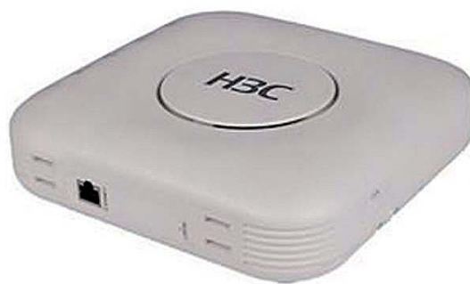
Figura 04 – Access Point para permitir a comunica333o entre o PDA e a rede corporativa.
