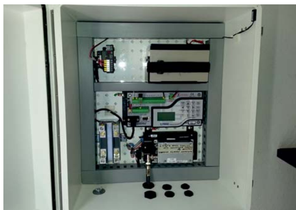
Figura 9: Estación con datalogger, radio, modem y batería.
