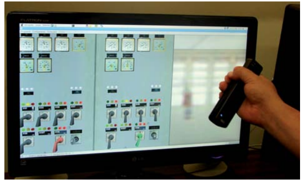
FIGURA 6 – O “wiimote” comandando um disjuntor
