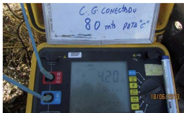
Gráfico 5: Teluómetro empleados (Fuente: Medición del sistema de PAT 2013, LT Mantaro – Socabaya)
