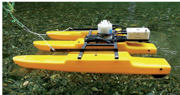
Figura 6: Perfilador Acústico Doppler (ADP).
