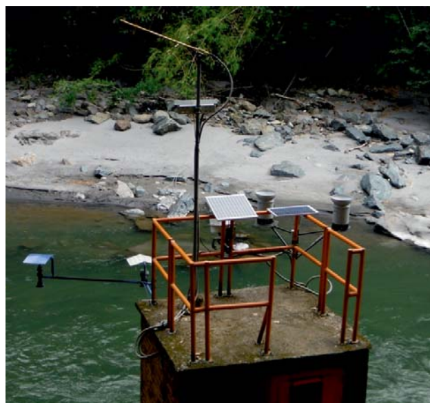
Figura 10. Estación con sensores de nivel tipo radar.
