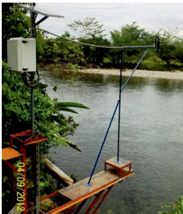
Figura 11: Estación automática con sensor de radar
