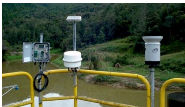
Figura 12: Estación satelital para medir nivel y precipitación.
