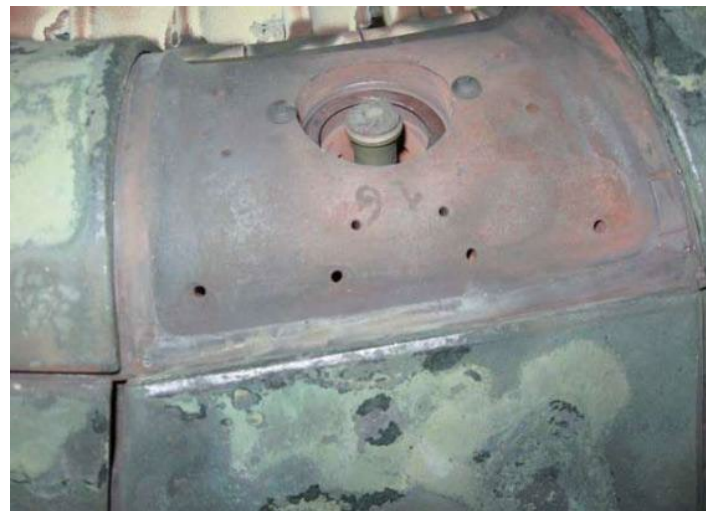
Fig. 4 Cuerpo del perno fracturado aún insertado en la cubierta interna
