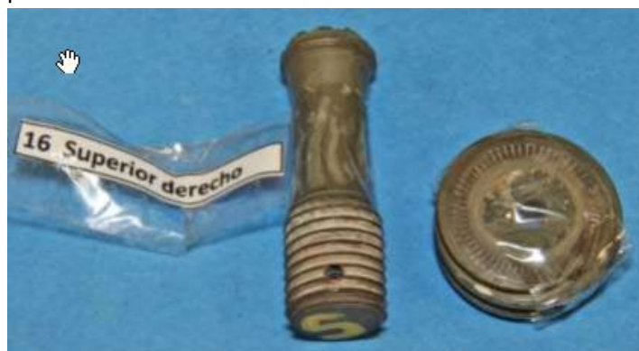
Fig. 6 Perno fracturado durante el desmontaje
