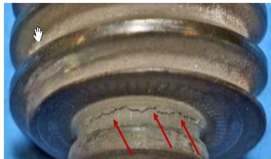
Fig. 7. Perno con fisuras visibles en la zona del cuello
