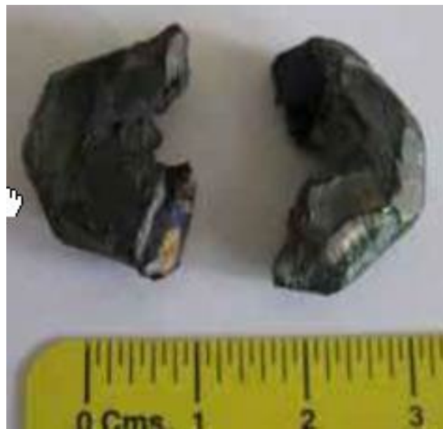
Fig. 5 Cabeza del perno fracturado hallada en el difusor de escape
