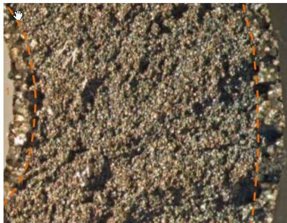
Fig. 8. Morfología intergranular de la zona de fractura del perno causante del daño (Imagen de ampliación media)
